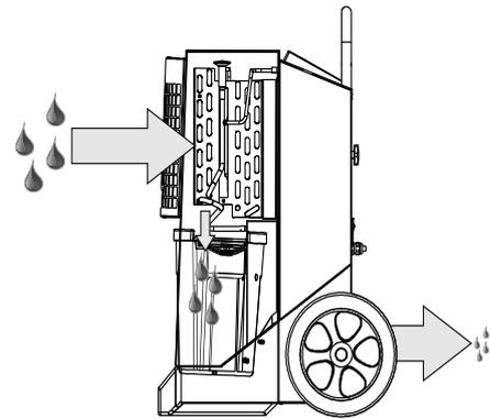
Aufgrund des wiederholten Luftstromes durch den Entfeuchter wird die Luftfeuchtigkeit ständig reduziert. So ist eine schnelle, schonende Trocknung möglich.
